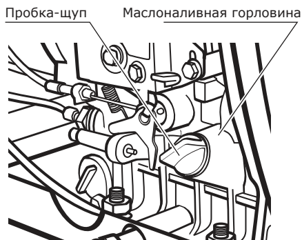
Рис. 2 Заполнение масляного картера
