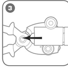
**3** Используя нож для продольного реза и призматический ролик, разрежьте изоляцию вдоль кабеля.
