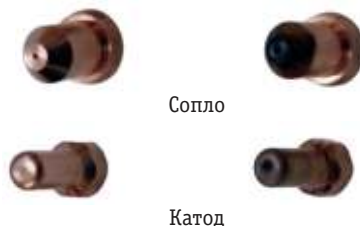
Рис. 7.6. Износ сопла и катода.
