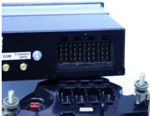
Рисунок 7. Спидометр с разъёмом: ISO 16844-2:2011
